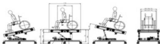
Fig. 1 실내주행 테스트 장치 도면
